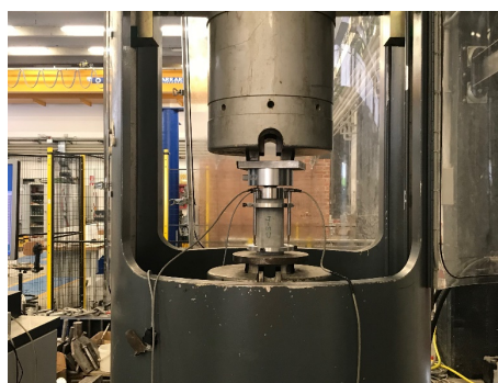
Determinazione del modulo elastico secante di una malta da ripristino fibrorinforzata (UHPFRC)
