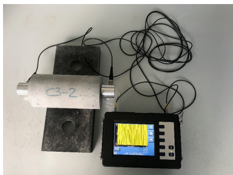
Determinazione della velocità di trasmissione degli ultrasuoni in malta alleggerita
