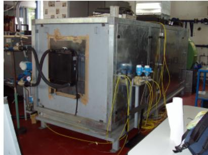
**Banco dinamometrico per prove su dischi freno.** Permette di studiare il comportamento aerodinamico e di scambio termico dei dischi freno ventilati al variare della velocità del veicolo in condizioni di frenata controllate con e senza ventilazione forzata. Il banco prova è attrezzato per misurare il flusso d'aria di raffreddamento e il coefficiente di scambio termico convettivo interno e globale.
